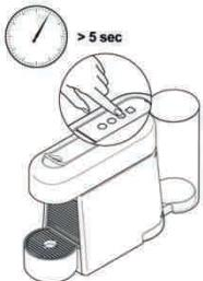
Pri vypnutom prístroji stlačte a podržte tlačidlo Horúca voda na 5 sekúnd. Tlačidlá na prípravu nápojov budú blikáť, a tým označovať aktuálne nastavenie.
