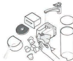
① **Leeren Sie die Abtropfschale,** die Restwasserschale und den Kapselbehälter täglich. Entfernen Sie auch Wassertank und Deckel, reinigen Sie sie mit einem geruchsfreien Reinigungsmittel und spülen Sie sie mit warmem/heißem Wasser aus.
