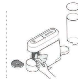
**② Osuszyć wszystkie części czystym ręcznikiem,** szmatką lub ręcznikiem papierowym i ponownie je zamontować. Regularnie czyścić výlot kawy i wnętrze ekspresu wilgotną szmatką.
