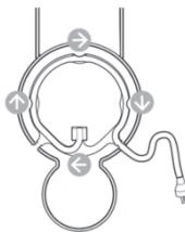
Regolare la lunghezza del cavo e fissare la porzione in eccesso sotto la macchina. Inserire la parte di cavo rimanente nel passacavo sotto il serbatoio dell'acqua, alla destra o alla sinistra della presa, a seconda della posizione scelta per il serbatoio. Assicurarsi che la macchina sia in posizione verticale.
