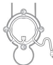
Upravte délku kabelu a zbývající část uložte pod kávovar. Přečnívající kabel vsuňte do vodicích drážek pod nádobou na vodu na levé nebo pravé straně, podle toho, kde se nádoba nachází. Zajistěte, aby byl přístroj ve svíšlé poloze.
