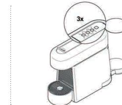
② A gyári értékek visszaállításának megerősítéseként a LED-ek 3-szor felvillannak. A készülék ezután automatikusan kikapcsol.
