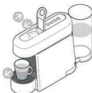
**5 Entnehmen Sie die Tasse.** Öffnen und schließen Sie den Hebel, um die Kapsel in den Kapselbehälter auszuwerfen.
