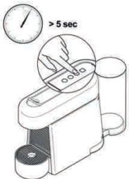
**Na vypnutém kávovaru** stiskněte a přídržte tlačítko Horká voda po dobu 5 sekund. Tlačítko na přípravu kávy začnou blikat podle aktuálního nastavení.
