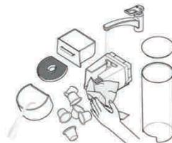
**① Codziennie opróżniać tacę ociekową,** podstawę ociekową i pojemnik na kapsułki. Wyjąć zbiornik na wodę wraz z pokrywą i oczyścić je za pomocą wilgotnej szmatki i bezzapachowego detergentu, a następnie przeplukać ciepłą lub gorącą wodą.
